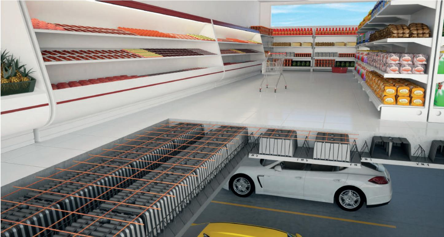
El sistema seguro y a la vanguardia para la realización de forjados de losa semiprefabricados (predalle) y hormigonados en obra con comportamiento monodireccional e intradós plano.
