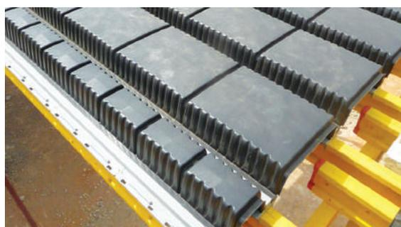
SKYRAIL es un sistema de casetones recuperables que permite realizar forjados monodireccionales con ventajas a nivel estructural gracias a la reducción de peso, a nivel de la obra por su sencillez y la seguridad de la colocación en obra, y a nivel de instalaciones por el hueco técnico que se crea entre las nervaduras del forjado. El sistema es totalmente transitable lo cual garantiza la máxima seguridad a los obreros.
