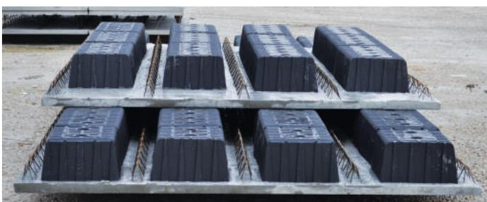
La losa comúnmente llamada "predalle" se define semiprefabricada puesto que una parte (generalmente compuesta por losa de base, entramado de encofrado y aligeramientos) se realiza en fábrica, mientras que la parte final, compuesta por encofrado superior y acabado, se realiza directamente en la obra.
